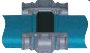
Die Klemmschelle um den Dichtungsring legen.
