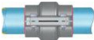
**03** Das zweite Rohr bis zu der markierten Linie in der Verbindungsanschluß einstecken.
