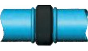
Das zweite Rohr in dem Dichtungsring bis zu der Bördelung einstecken.
