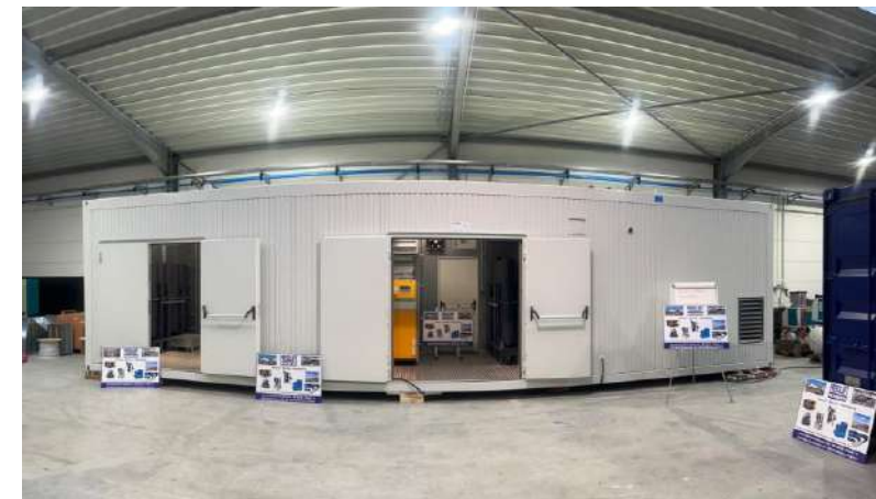
40' – WRT-CONTAINER – für N 2 Verdichtung 3x 15 Kw HD-BOOSTER-Anlagen – 300 bar
